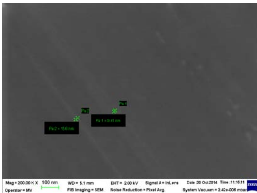
Fig. 2. Imagine SEM a probei F206 la mărirea de 200000X, cu detaliu al nano structurilor obținute (canale paralele de dimensiuni măsurate)
