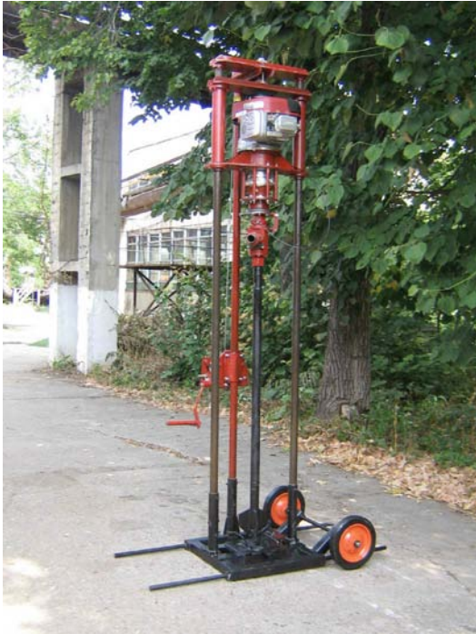
Fig. 1. Instalația de foraj FA100
