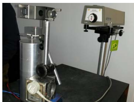
Fig. 5. Sistem de măsurare cu interferometru Agilent 5529B cu kit de măsurări liniare 55280A, utilizat pentru determinarea variației amplitudinii oscilației mecanice realizate de către miezul magnetostrictiv, în funcție de timp
