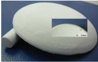
Fig. 3. Model experimental de proteză de implant cranian, cu grosimea medie de ~ 3,5mm
