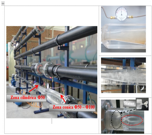
Fig. 1. Instalație pentru studiul curgerii rotaționale, bifazice, cu gradient advers de presiune
