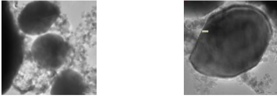
Fig. 2. Imagini TEM ale nanopulberilor de \text{Fe}_{0.50}\text{Co}_{0.50}/\text{Al}_2\text{O}_3 , procesate cu 4% sare precursoră a Al
