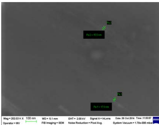
Fig. 3. Imagine SEM a probei F207 la mărirea de 200000X, cu detaliu al nano structurilor obținute (canale paralele de dimensiuni măsurate)
