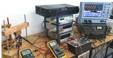
Demonstrator experimental – sistem de caracterizare a proprietăților magnetice în frecvență
