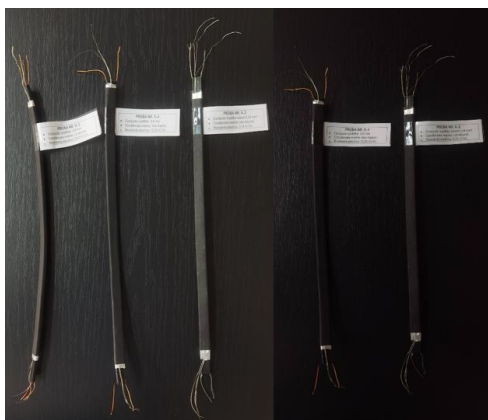
Fig. 1 – Modele funcționale de cablu de încălzire cu efect de autoreglare termică
