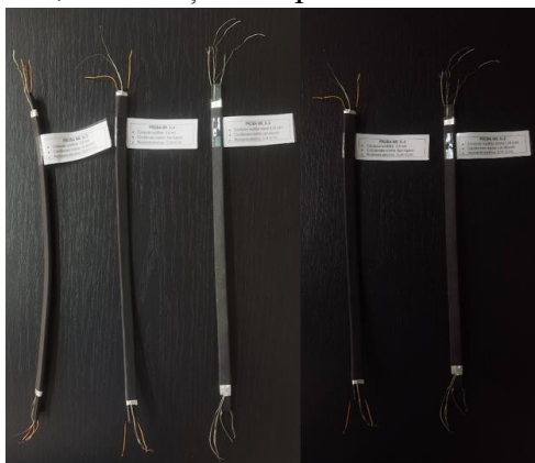
Fig. 1 – Modele funcționale de cablu de încălzire cu efect SRT
