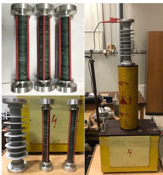
Fig. 2. Asamblarea și testarea funcțională a prototipurilor de MOV disc.
