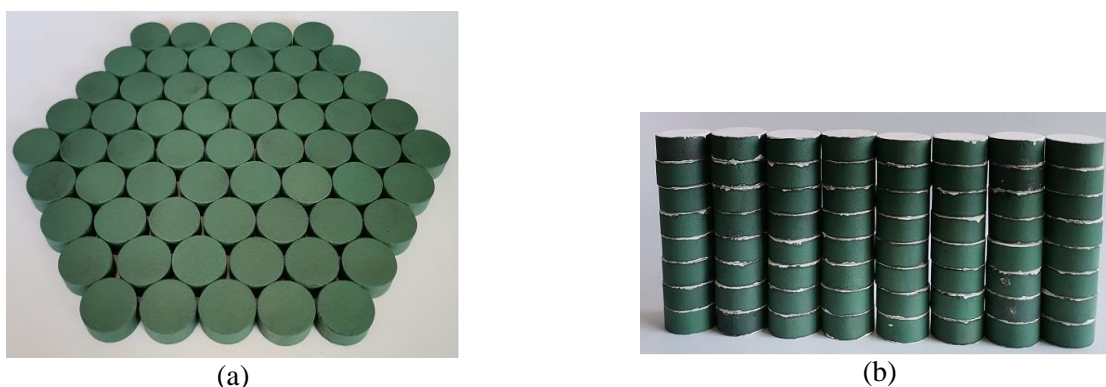
Fig 1. Aspectul macrografic al prototipurilor de MOV disc realizate prin metalurgia pulberilor: (a) neacoperite și (b) acoperite cu un strat de Ag pe suprafețele circulare.
