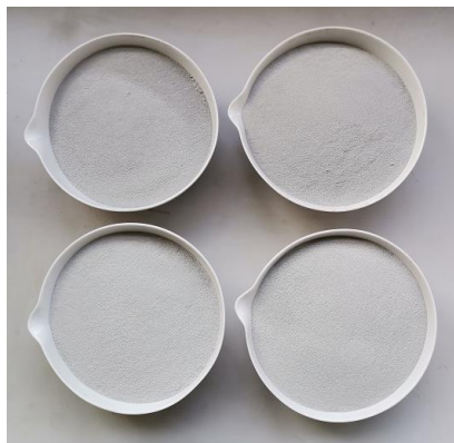
Fig 2.1. Aspectul macrografic al pulberii D5 (lot de 3 kg) pentru realizare MF de MOV disc prin MP.
