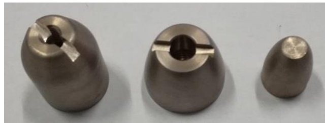
Fig. 2.4. Aspectul pieselor finite de tip varfuri de contact din materiale compozite sinterizate pe baza de W-Cu, realizate conform desenelor de executie elaborate de SC MAIRA MONTAJ SRL.
