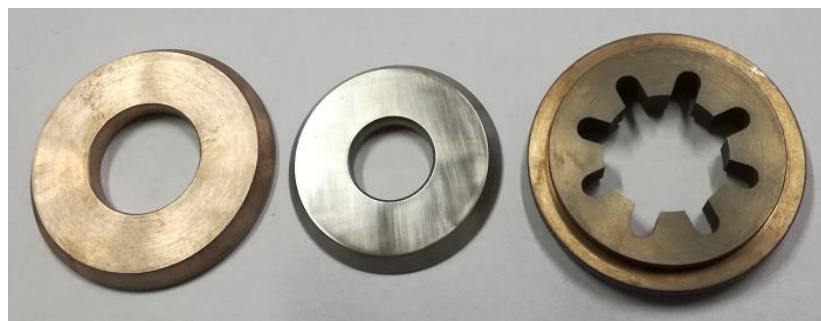
Fig. 2.5. Aspectul pieselor finite de tip inele de protectie din materiale compozite sinterizate pe baza de W-Cu, realizate conform desenelor de executie elaborate de SC MAIRA MONTAJ SRL.
