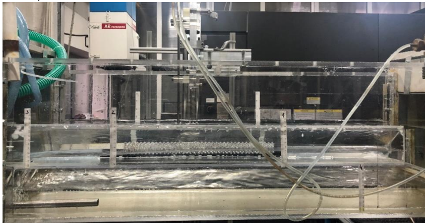
Fig. 1. Vedere stânga asupra modelului hibrid de priză de apă cu barieră comportamentală Eco-WIBB
