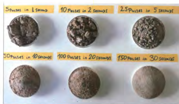
Fig. 17 Succesiunea etapelor de fragmentare selectiva prin aplicarea impulsurilor electrice repetitive de inalta tensiune, asa cum este ilustrata de firma SEFRAG (pentru comparatie).
