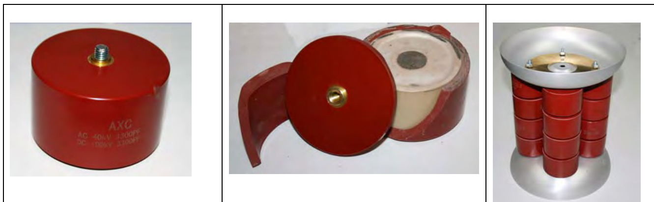
Fig. 9. Realizarea bateriei de condensatori (10nF) de înaltă tensiune și inductivitate redusă.
