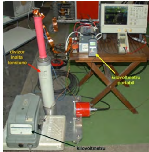
Figura 16. Montajul experimental folosit pentru teste electrice
