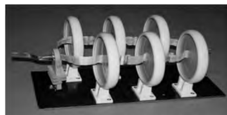
Figura 11. Dispunerea condensatorilor ceramici în montaj serie-paralel
