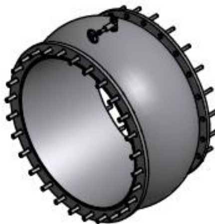
Fig. 35, Proiectarea noului tronson al aspiratorului
