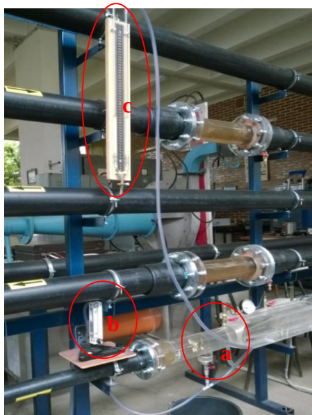
Fig. 1. Măsurarea pierderii de sarcină prin aerator
