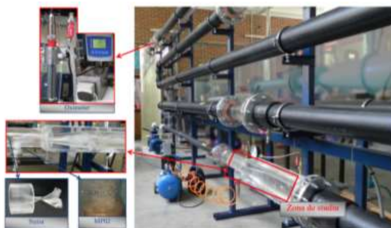
Fig. 2.1. Instalatia experimentală pentru studiul curgerii rotaționale, bifazice, cu gradient advers de presiune
