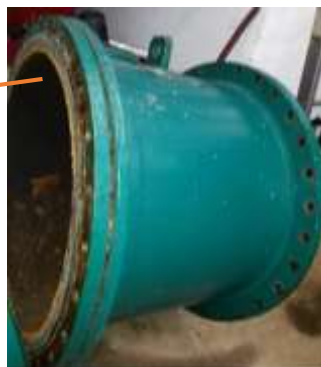
Fig. 4.3. Primul tronson al conului aspirator, pe care se va monta dispozitivul
