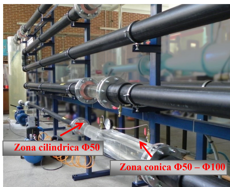
Fig. 4. Vizualizarea curgerii rotaționale cu gradient advers de presiune
