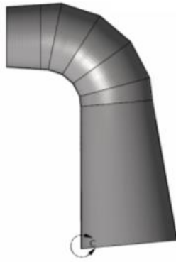
Fig. 25. Geometria aspiratorului turbinei FO 230/270
