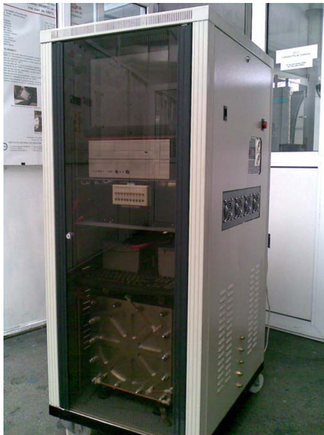
Figura 1. Model functional de sistem energetic integrat pe baza de pile de combustie realizat la INCDIE ICPE-CA
