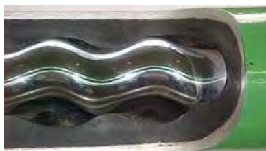
Fig. 1: Cupla rotor –stator a pompelor cu cavități progresive
