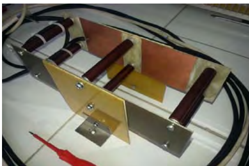
Figura 7. Configuratia de amplasare a electrozilor de polarizare cu conexiunile aferente
