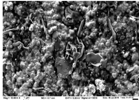
Fig. 11. Imaginea SEM pentru 0.6\text{BiFeO}_3 - 0.4\text{BaTiO}_3 sinterizata la 1050^\circ\text{C} pentru 2 ore.
