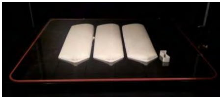
Fig. 2. Pale imprimate în camera de lucru a imprimantei
