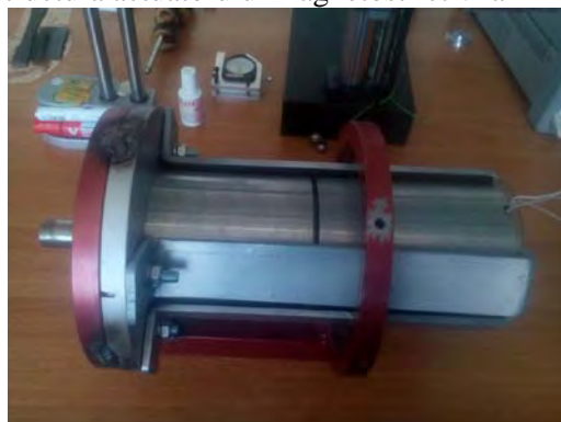
Fig.5 Modelul experimental de actuator magnetostrictiv (vedere laterală).
