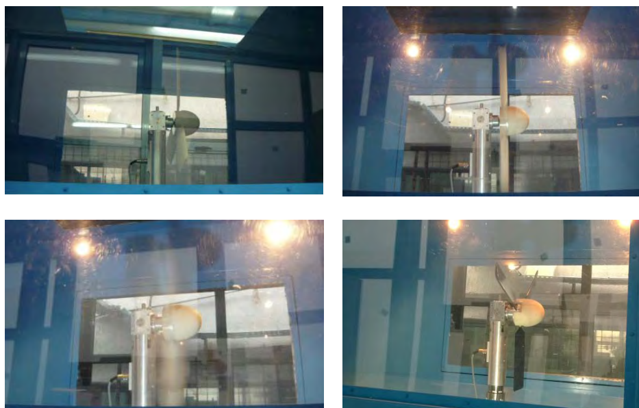
Fig. 8. Testarea modelelor experimentale în tunelul aerodinamic
