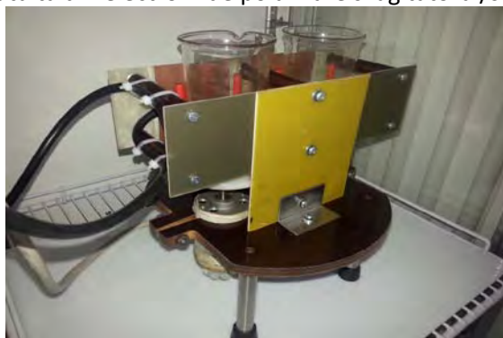
Figura 9. Instalatie experimentală de aplicare a câmpului electric amplasată în camera climatică
