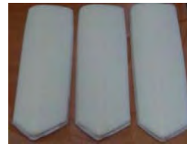
Fig. 3. Dezlipirea palelor de pe materialul suport
