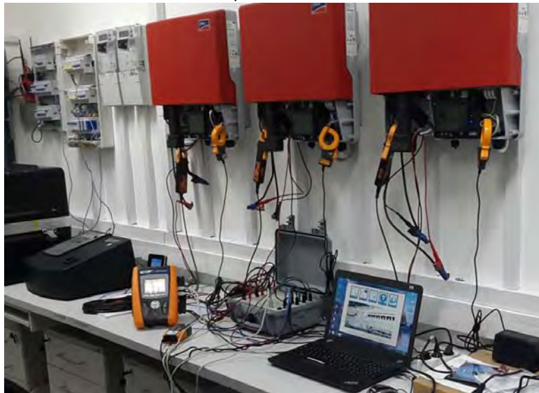
Fig. 1. Standul 1 de testare realizat pentru achiziția parametrilor de funcționare a CEF.
