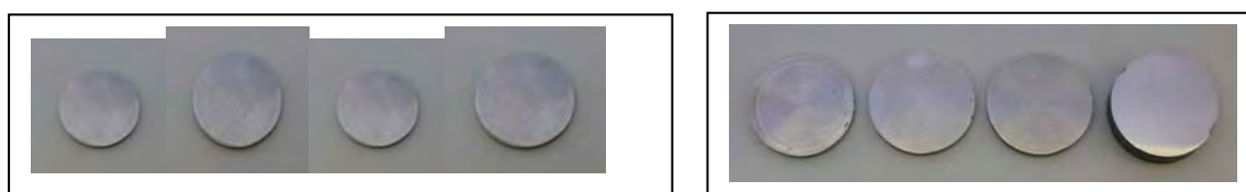
a) Modele Experimentale sinterizate AHSS
