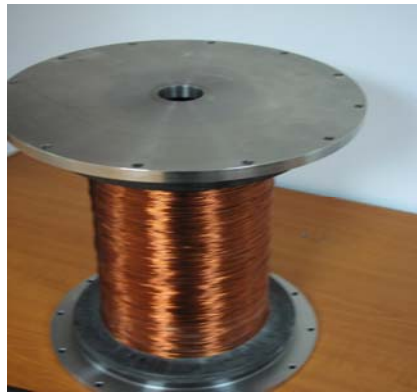
Bobina supraconductoare Nb-Ti (solenoid) pentru camp magnetic 5T.
