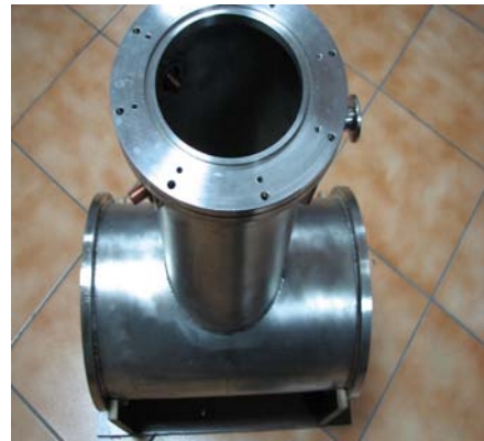
Criostatul bobinei supraconductoare
