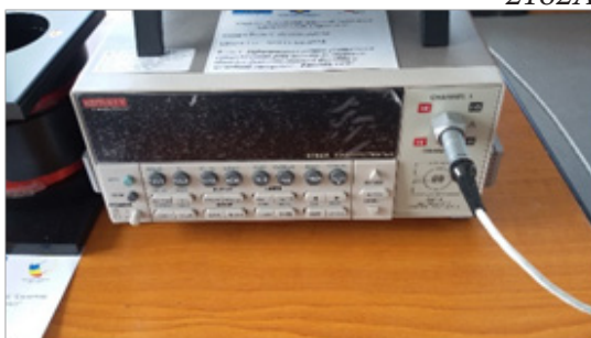
Nanovoltmetru 2182A Keithley type
