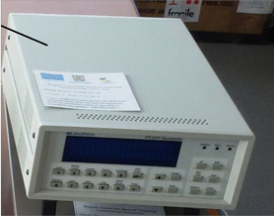
Gaussmeter 475 DSP type
