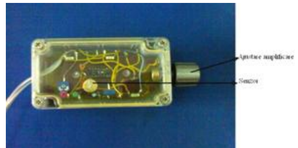
Fig. 6. Senzor si aparat pentru detectia CO 2 cu strat sensibil polimeric (sursa ICPE-CA)
