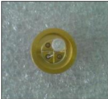
Fig. 5: Senzor pentru detectia CO 2 cu strat sensibil oxizi semiconductori (sursa ICPE-CA)
