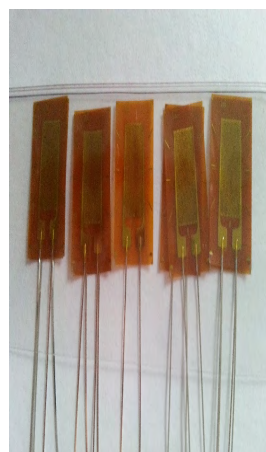
c. Marci tensometrice pentru masurarea deformatiilor mecanice.
