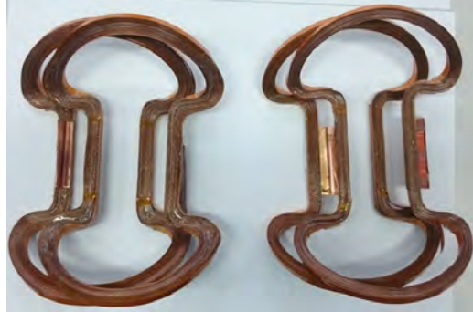
Fig. 2.3. Bobinele supraconductoare HTS sub forma de „sa”.
