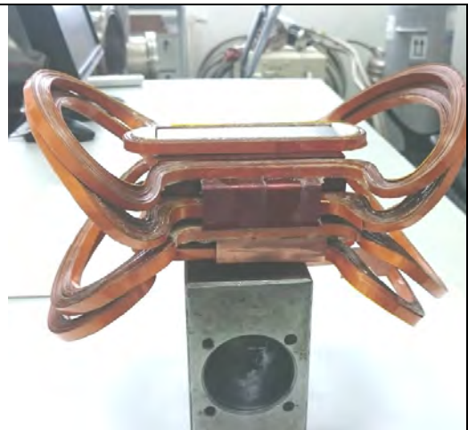
Fig. 2.6. Vedere laterala a suportului cu bobinele montate.
