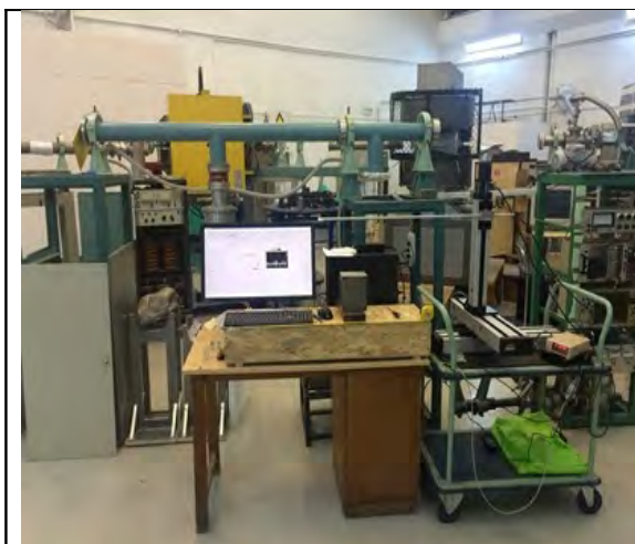
Figura 2.5. Procesul de achiziție cu sonda Hall a datelor de câmp magnetic generate de un magnet calibrat dintr-un spectrometru ionic (parabola Thomson).
