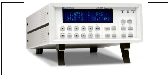
Fig. 1.28. Gaussmetrul Lake Shore model 475.
