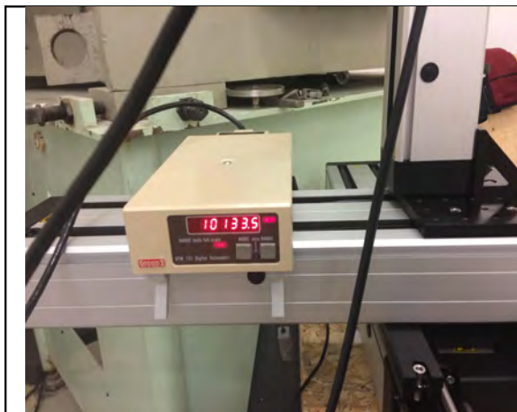
Figura 2.9. Moment din procesul de achiziție de date prin Gaussmetrul digital.
