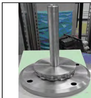
Fig. 6 Vedere laterala a dispozitivului de derulare si tensionare a firului supraconductor (pentru bobinaje planare)
