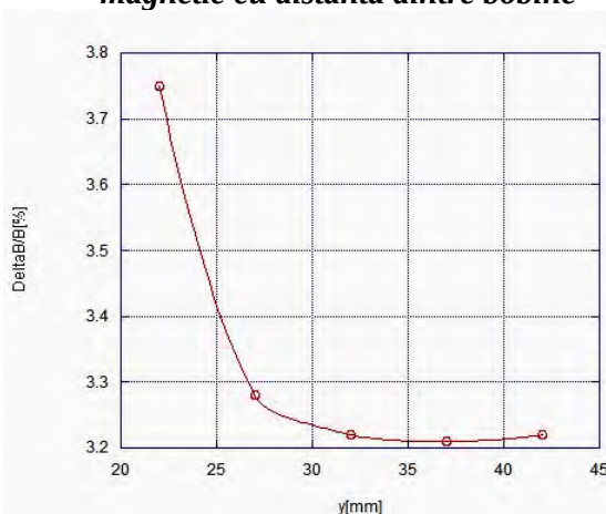
Figura 3.10. Dependenta uniformitatii campului magnetic de raza interioara de curbura a bobinelor
