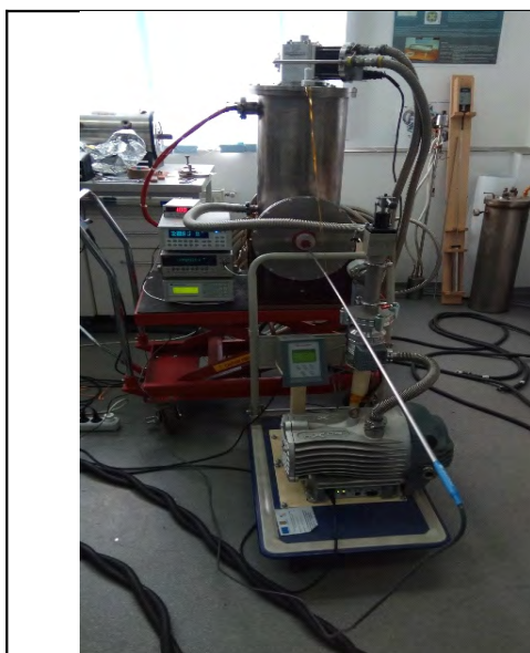
Fig.1.29. Ansamblul EMSD si sistem de masura a campului magnetic.
