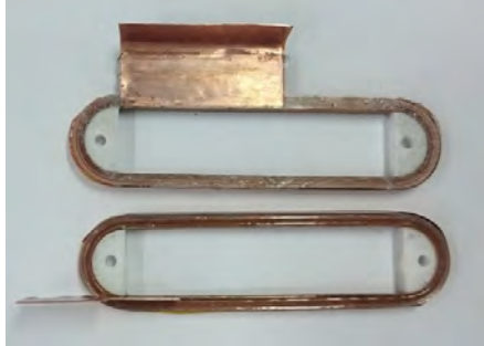
Fig. 2.2. Bobinele supraconductoare HTS tip stadion.
