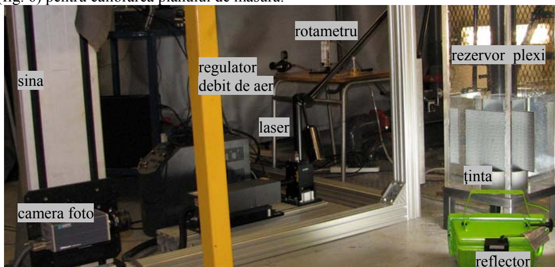
Fig. 5, Reglarea primului plan de măsură: camera foto, plan laser, ținta de calibrare
