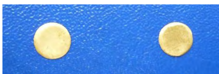
Figura 3. Electrozi de injecție de curent realizați din aur (Au).
