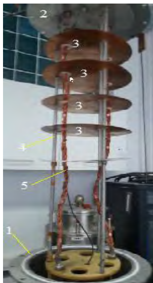
Fig. 5.5. Ansamblul criostat – sistem de sus-ținere crio electromagnet
