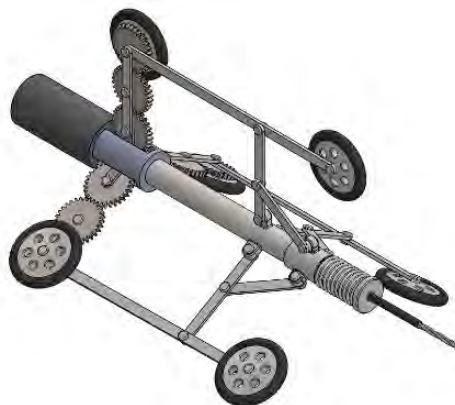
Fig. 12. Soluția constructivă a robotului de inspecție cu roți V2: a) Modelul CAD 3D al robotului de inspecție cu roți V2; b) Schema cinematică.
