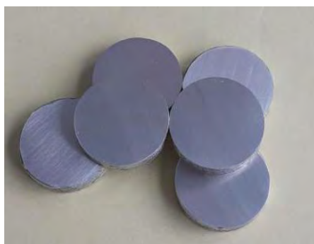
Aspectul macrografic al ME-S din aliaje de Mg, realizate prin procedeul SPS la 450°C/5 min.
