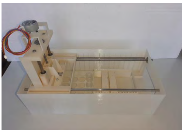
Sistemul electromecanic de preluare automata a probelor realizat
