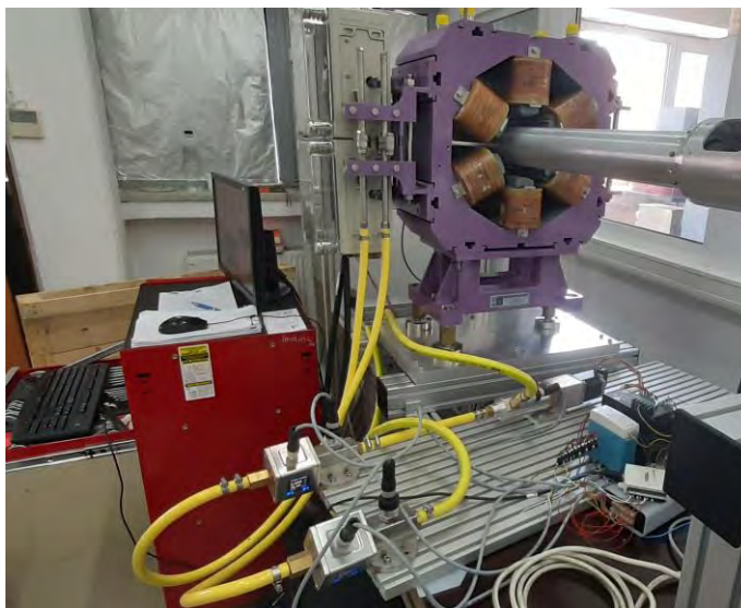
Fig. 1. Standul cu regulator de presiune, având montat un electromagnet de tip sextupol.
