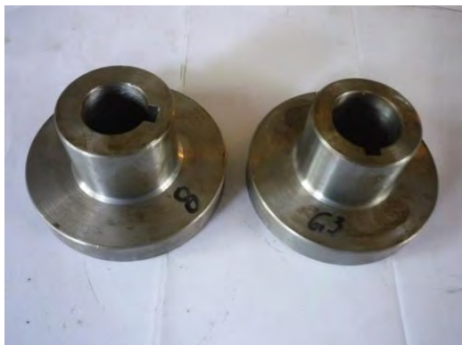
Fig.7. Reperele fabricate „Semicupla 1” și „Semicupla 2”, subansamblul „Cuplaj elastic cu disc frontal”
