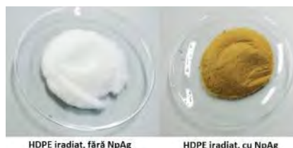
Fig. 1.14 - Exemplu tipic de nanocompozit HDPE/NpAg
