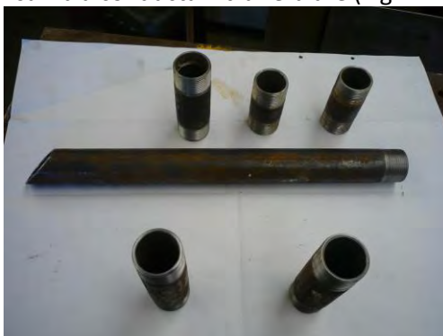
Fig.14. Conductele de instalație hidraulică, cu filet 1-1/4'' fabricate
