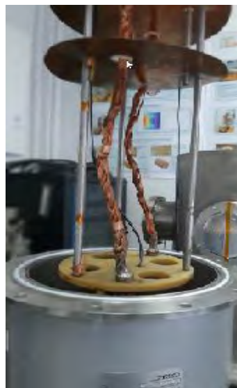
Fig. 5.6. Detaliu ansamblu criostat – sistem susținere și alimentare.
