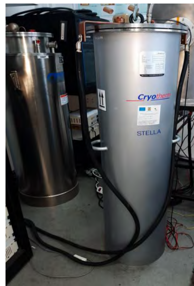
Fig. 5.7. Crio-electromagnet asamblat integral, alimentat de la sursa de c.c.
