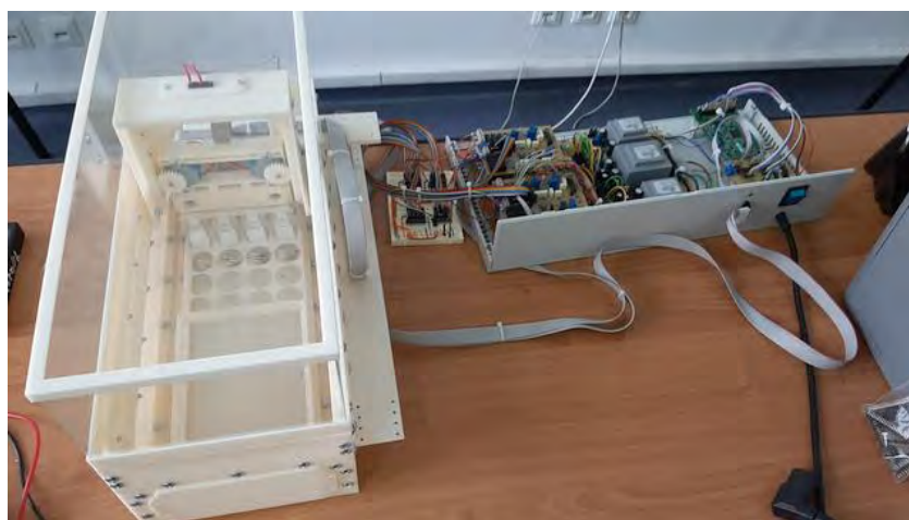
Foto 1. Incinta termostatăă în care se pot manipula electrozii și electronica de comandă aferentă
