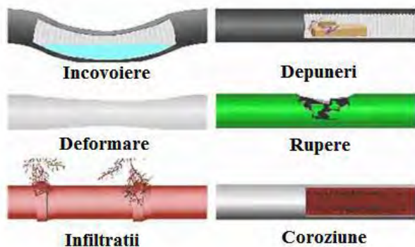
Fig. 7. Defecte uzuale în țevi.
