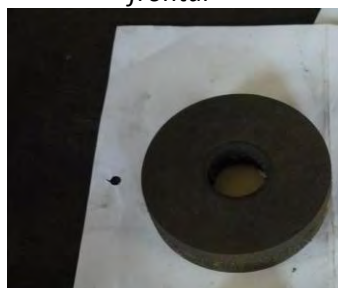
Fig.9. Reperul fabricat „Disc elastic”, subansamblul „Cuplaj elastic cu disc frontal”
