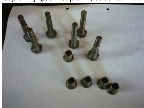
Fig.8. Reperele fabricate „Șurub de păsuire M8” și „Bucșa cu umăr”, subansamblul „Cuplaj elastic cu disc frontal”
