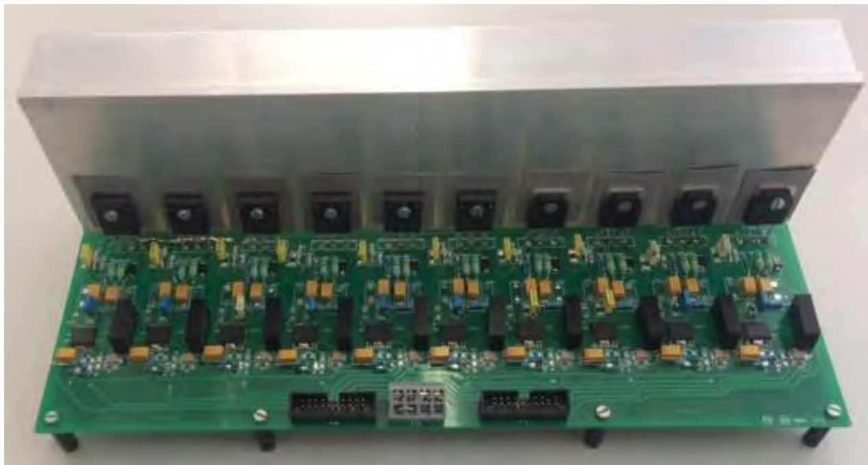
Figură 2 Placa electronica cu puntea de tranzistoare montate pe radiator
