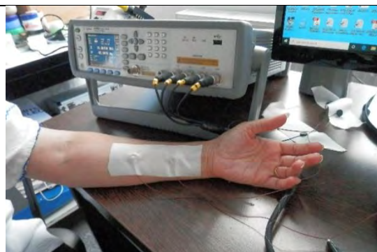
Figura 15. Imaginea montajului pentru efectuare de măsurători de impedanta in funcție de frecventa.
