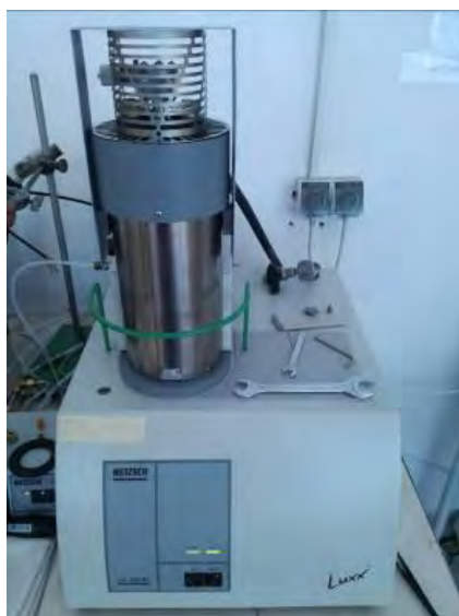
Figura 1.16. Echipamentul STA 409 PC utilizat la determinarea temperaturii Curie
