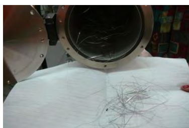
Fig. 3.2 Aspecte din timpul prelevării din ‘buzunarul’ sistemului melt-spinning a benzilor de aliaj Alnico
