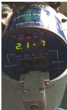
Figura 1.2 Nivelul vidului înregistrat în incinta camerei de tratament
