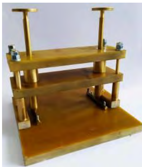
Fig. 1.2 Dispozitiv pentru masurare impedanta microfie
