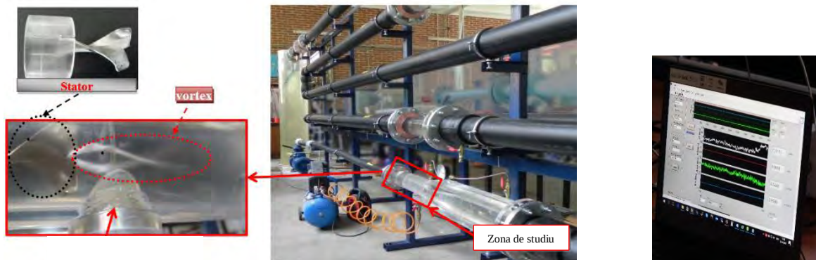
Fig. 1. Stand pentru studiul curgerilor bifazice, rotaționale, cu gradient advers de presiune
