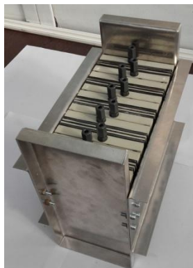
Figura III.2. Stack de 5 celule elementare legate in serie cu ajutorul jugurilor de curent
