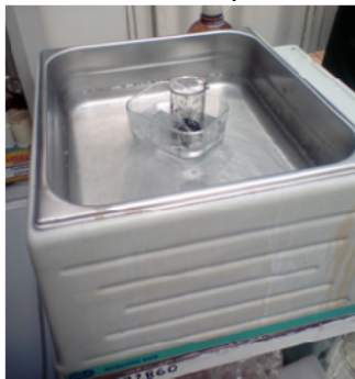
Fig. 6.27 Nanotuburi MWCNT disperstate prin ultrasonare pe baie de gheață.
