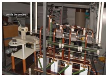
Fig.6.1 Adaptarea generatorului de impulsuri repetitive: schimbarea rezistențelor și adaptarea celulei de proces.
