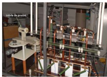
Fig. 5.1 Adaptarea generatorului de impulsuri repetitive: schimbarea rezistențelor și adaptarea celulei de proces.
