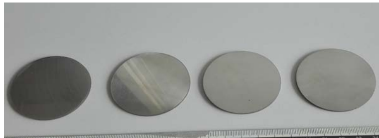
Fig. 2.1. ME sub forma de tinte pe baza de FeCoNiAlCu.
