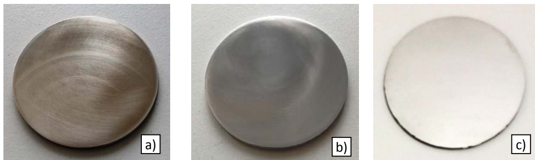
Fig. 1.1. ME de tinte de pulverizare realizate prin SPS din pulberi de: (a) Ti, (b) Al, (c)Ti-Al 75-25 % at.
