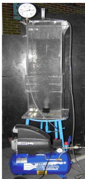
Fig. 2.1, Instalație pentru testarea unui GBF \Phi 50
