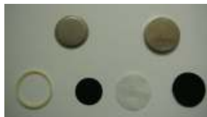
Componente supercapacitor: capsule, garnitură, electrozi, membrane separatoare
