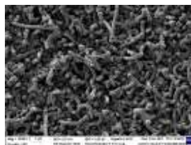
Imagini SEM CNT cu depuneri de polipirol prin voltametrie ciclică
