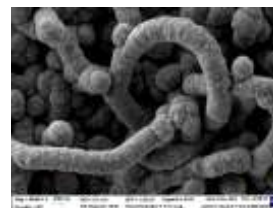
Imagini SEM CNT cu depuneri de polipirol prin voltametrie ciclică
