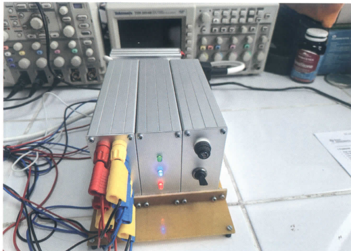
Fig. 7 Modulul electronic al surselor de alimentare stabilizate, izolate și protejate, cu aplicații în medicină, realizare practică.
