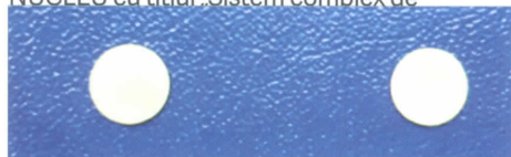
Fig. 1 Electrozi de injecție de curent, fabricați din Ag de puritate 99,99 %, având diametrul și grosimea de: \Phi = 10 \text{ mm} \pm 0,1 \text{ mm} și h = 0,5 \text{ mm} \pm 0,1 \text{ mm}
