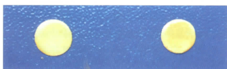
Fig. 3 Electrozii de detectare a biopotentialului electric, fabricați din Au, având diametrul și grosimea de: \Phi = 10 \text{ mm} \pm 0,1 \text{ mm} și h = 0,5 \text{ mm} \pm 0,05 \text{ mm}
