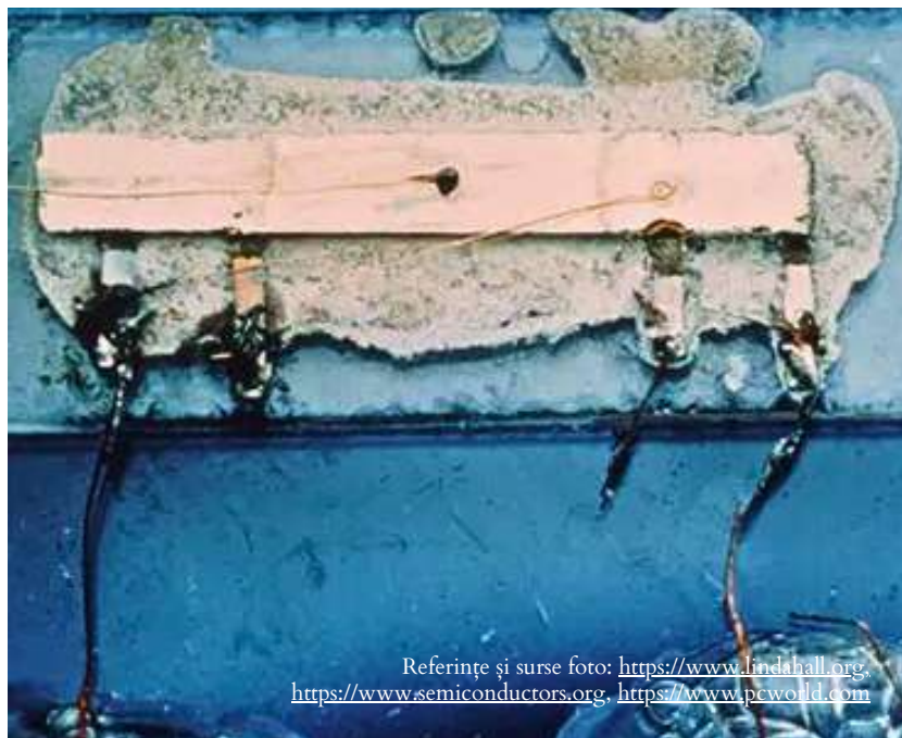
Primul circuit integrat de lucru, construit de Jack Kilby, septembrie 1958 (Texas Instruments)
