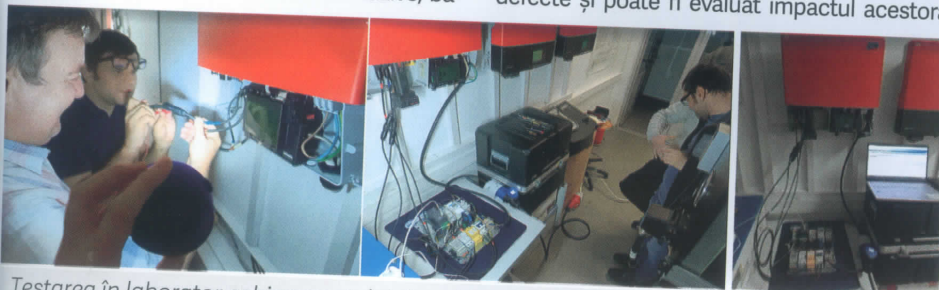
Testarea în laborator echipamentului de monitorizare a parametrilor electrici și de mediu
