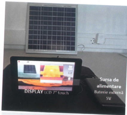
Fig. 2 Model experimental de detecție a defectelor folosind cameră termografică
