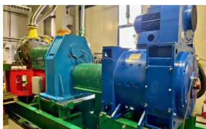
Lanțul cinematic al bancului de teste
