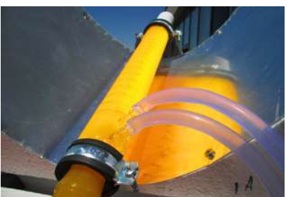
Foto 3, 4: Fotoreactor cu urmărire automată a Soarelui, amplasat pe un telescop care poate urmări radiația solară pe întreaga perioadă a procesului de fotocataliză
