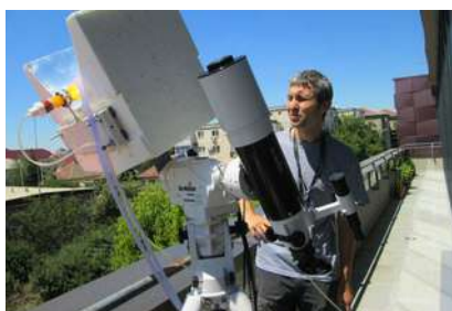
Foto 3, 4: Fotoreactor cu urmărire automată a Soarelui, amplasat pe un telescop care poate urmări radiația solară pe întreaga perioadă a procesului de fotocataliză
