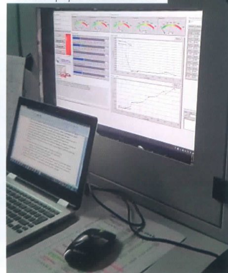
D3 - Stand de testare motoare Diesel - pupitrul de comandă
