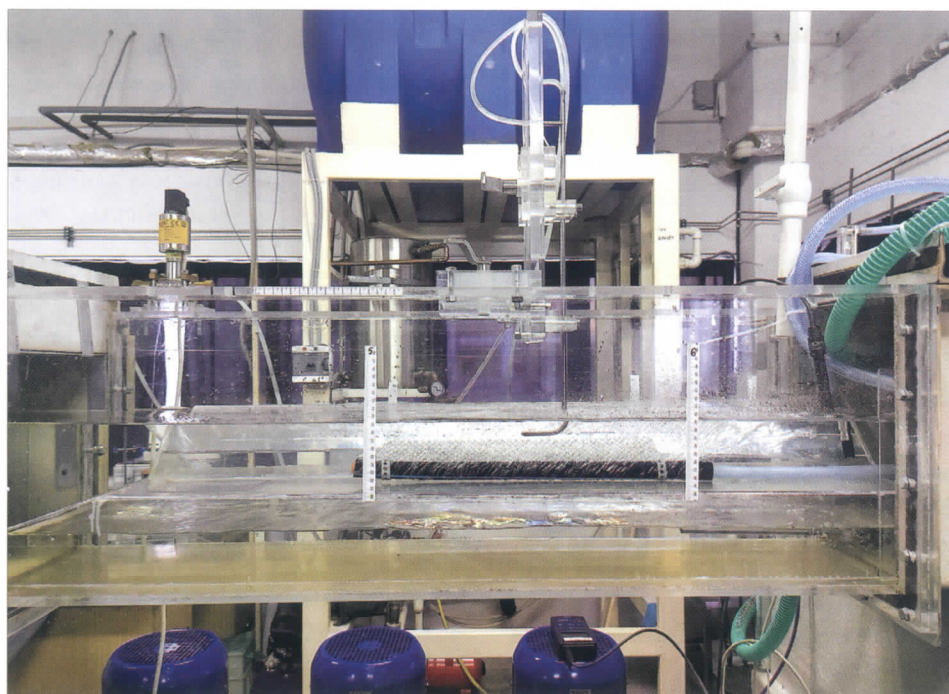
Fig. 2 Modelul experimental al prizei ecologice de apă cu barieră comportamentală – vedere de ansamblu
