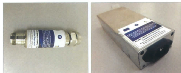
Fig 2. Filtre TEMPEST dezvoltate pentru electroalimentare, adaptate la impedanța de rețea
