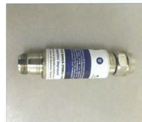
Fig 2. Filtre TEMPEST dezvoltate pentru electroalimentare, adaptate la impedanța de rețea
