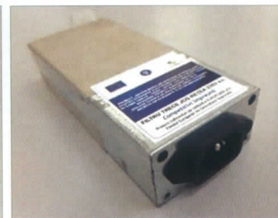
Fig 2. Filtre TEMPEST dezvoltate pentru electroalimentare, adaptate la impedanța de rețea
