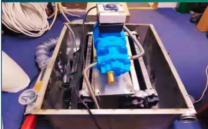
POMPA RECIRCULARE A ULEIULUI FIERBINTE PENTRU INCARCARE ENERGIE
