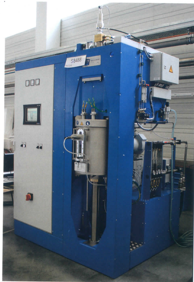
Fig. 3 Instalație de sinterizare în plasmă de scânteie (SPS)
