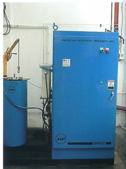
Fig. 1 Presă izostatică la cald
