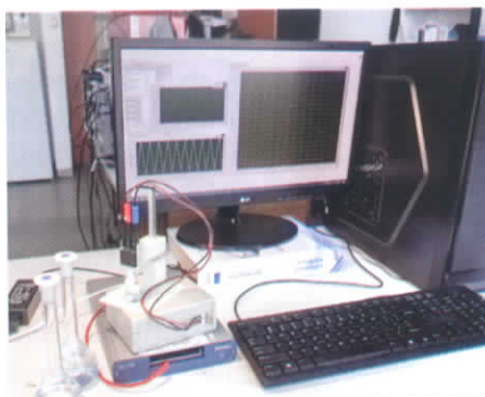
Fig1. Echipament mobil pentru detecția pesticidelor de tip carbendazim
