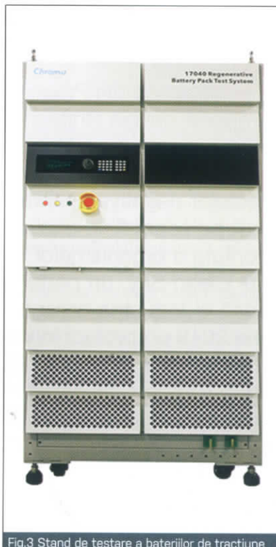
Fig.3 Stand de testare a bateriilor de tracțiune
