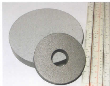
Figura 2. Rezistențe de volum pentru circuitul electric de protecție al vagonelor de călători CFR.
