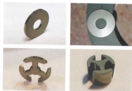
Fig. 6 Inele, miez rotor și stack de 4 miezuri rotorice sinterizate din nanopulberi FeCo izolate electric
