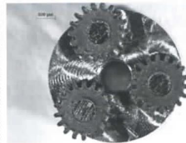
Folosind această tehnologie s-au realizat microstructuri mecanice simple - de tipul-grinzi incastrate (cantilever), găuri și canale cu dimensiuni de ordinul zecilor de micrometri, precum și structuri complexe - de tipul roților dințate, a reducătoarelor planetare cu roți dințate cu profil cicloidal, micropompe cu membrane cu decupări interioare și dispozitive microfluidice de unică folosință, cu aplicații în medicină, biologie și toxicologie.
