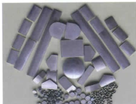
Cu o tradiție în domeniul materialelor de contact electric de peste 55 ani, ICPE-CA a dezvoltat de-a lungul anilor, în cadrul unor programe complexe sau prin contracte directe cu beneficiari industriali, diverse clase de materiale de contact pentru realizarea de contacte electrice sinterizate pentru aparataj electric de comutație de joasă, medie și înaltă tensiune.
