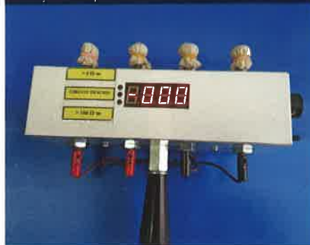
Fig. 1. Aparat destinat măsurării in situ a rezistivității electrice a structurilor de rezistență din beton armat. Caracteristici: măsurarea rezistivităților cuprinse în plaja 5 \Omega \div 100 \Omega , indicarea optică a valorilor sub 5 \Omega și a celor peste 100 \Omega
