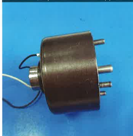
Fig. 3. Actuatorul electromagnetic cu acțiune proporțională, caracteristici: excursia echipamentului mobil este de 0 – 15 mm; frecvența semnalului dreptunghiular, f = 24 \text{ kHz} , factorul de umplere reglabil, k = 10\% - 90\% , amplitudinea vârf la vârf U_{p-p} = 24 \text{ V}
