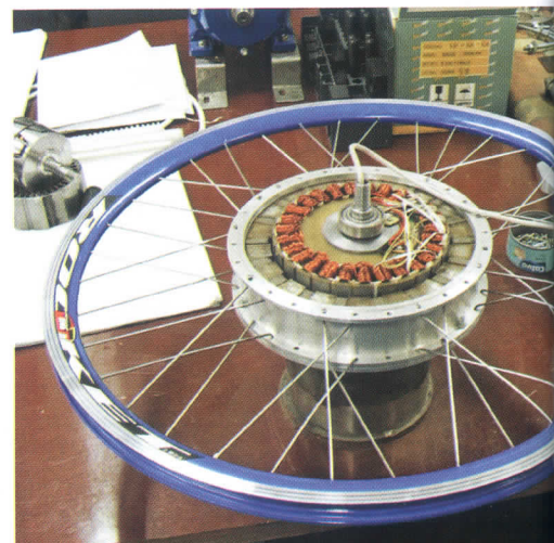
Fig. 1 Sistem de acționare roată de bicicletă electrică
