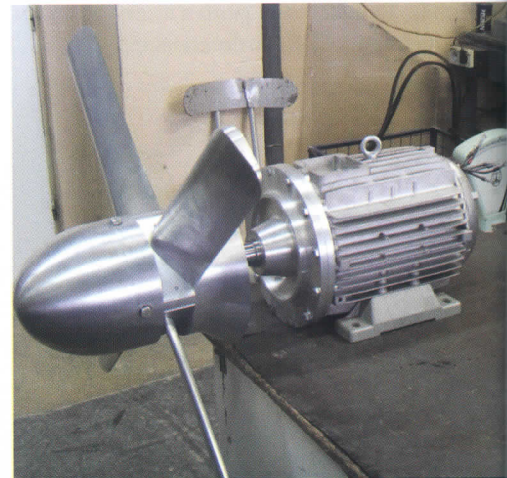
Fig. 5 Turbină hidrolică neintubată cu generator sincron de 2kW, la 250 rpm
