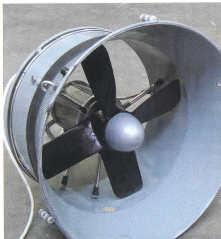
Fig. 4 Turbină cinetică hidrolică intubată cu generator sincron de 150W, la 500 rpm
