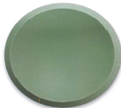
Figura 3. Model experimental de calotă craniană din ceramică
