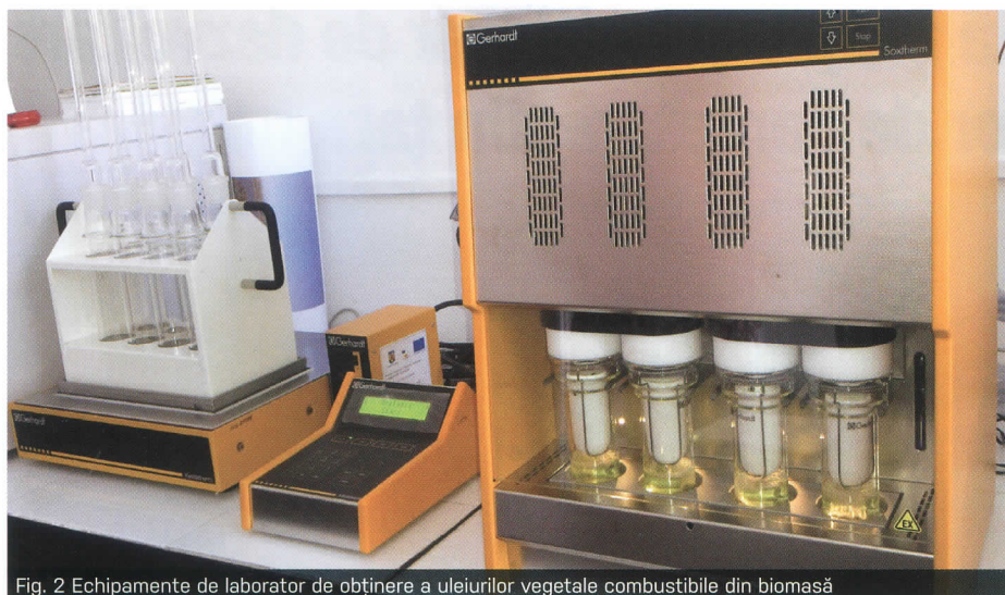
Fig. 2 Echipamente de laborator de obținere a uleiurilor vegetale combustibile din biomasă
