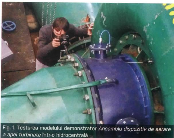
Fig. 1. Testarea modelului demonstrator Ansamblu dispozitiv de aerare a apei turbine într-o hidrocentrală
