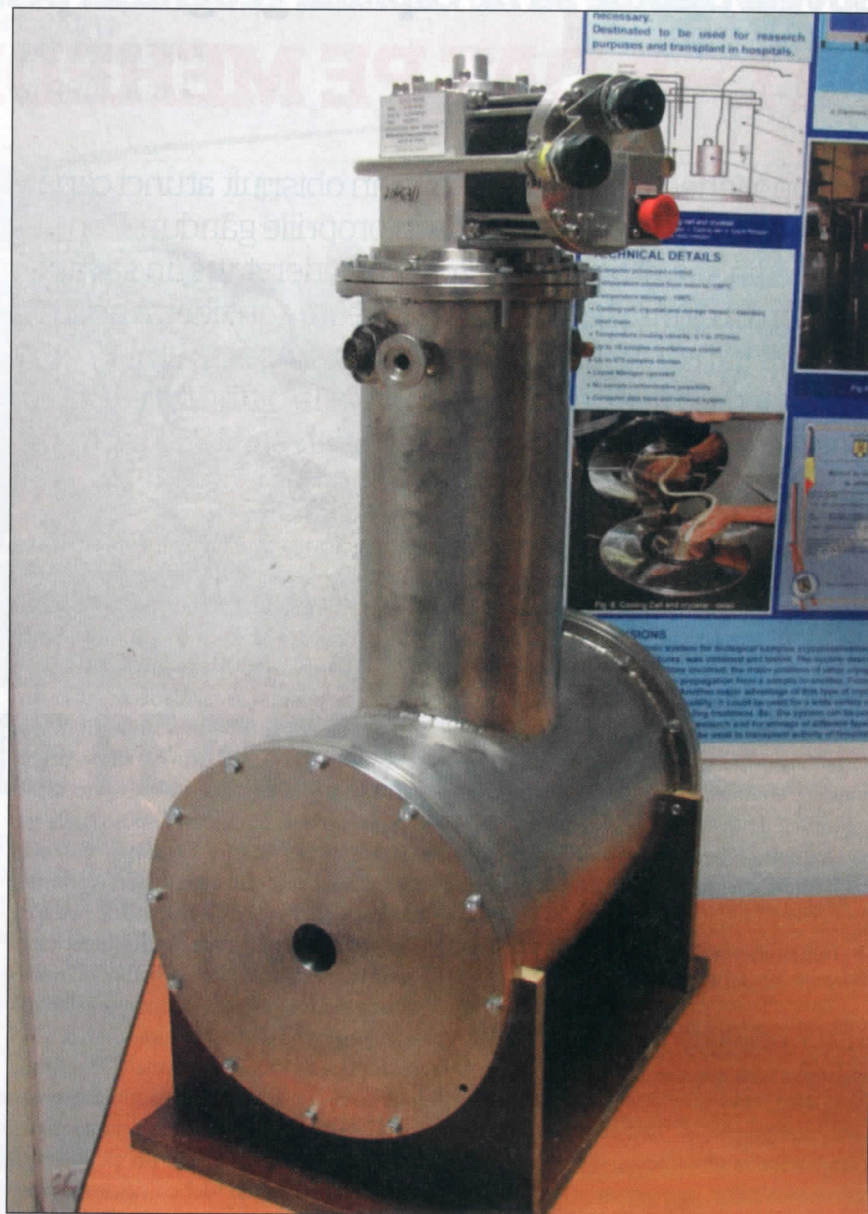
Electromagnet supraconductor generator de câmp magnetic intens și uniform (3T) realizat în ICPE-CA (foto ICPE-CA)
