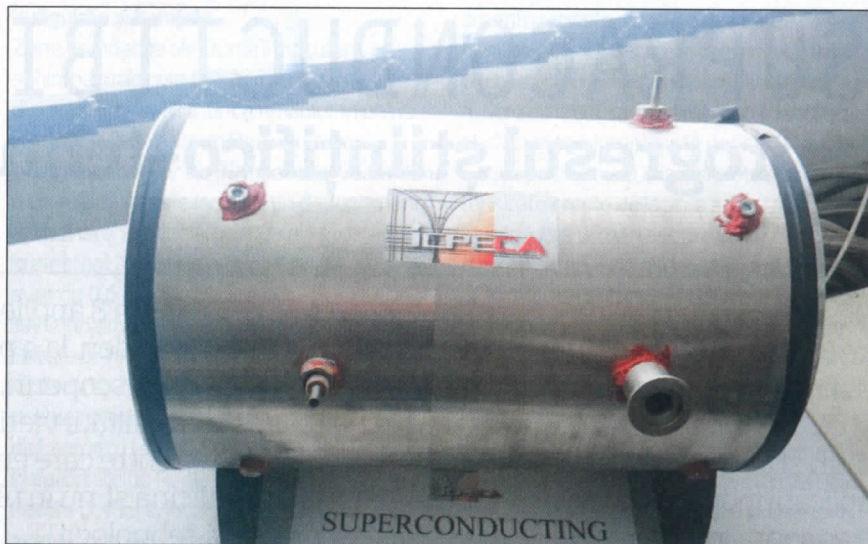
Fig. 2. Generator Electric Supraconductor realizat prototip în ICPE-CA (foto ICPE-CA)
