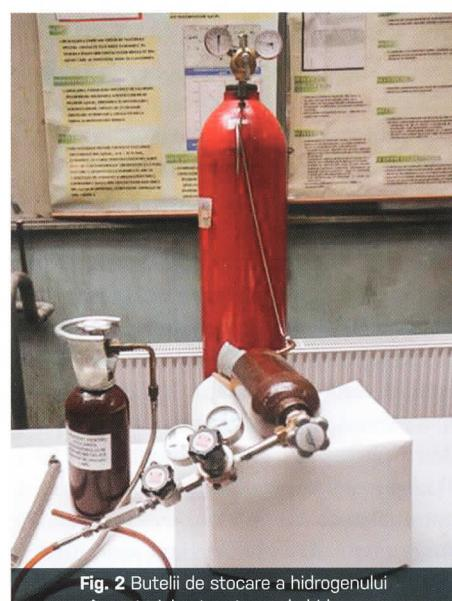
**Fig. 2** Butelie de stocare a hidrogenului în materiale stocatoare de hidrogen
