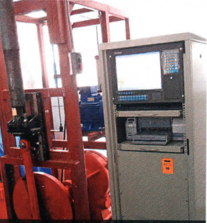
Ștand pentru testarea și diagnosticarea computerizată a amortizoarelor pentru vehicule feroviare
