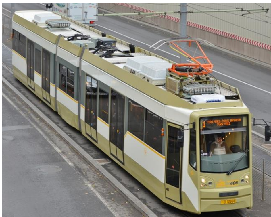
Figura 8. Bucur Low Floor – tramvai nou cu tracțiune în curent alternativ
