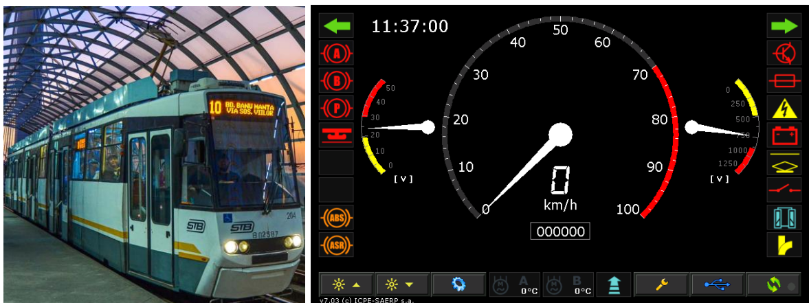
Figura 7. V3A-93-CA modernizare cu tracțiune în curent alternativ
