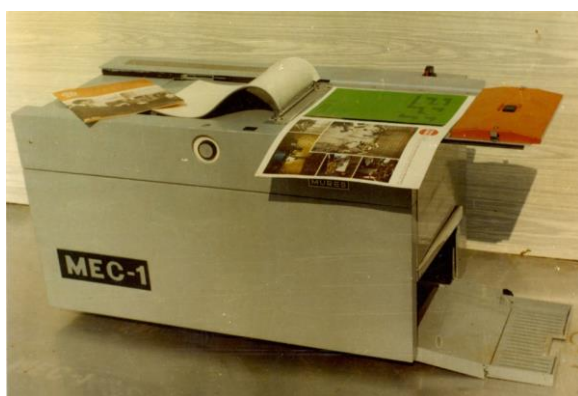
Fig. 7. Mașini electrostatice de copiat MEC 1 și MEC 2
