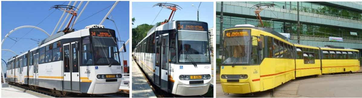
Figura 5. Tramvaie modernizate V3A-93CH-PPC cu variator de tensiune continuă
