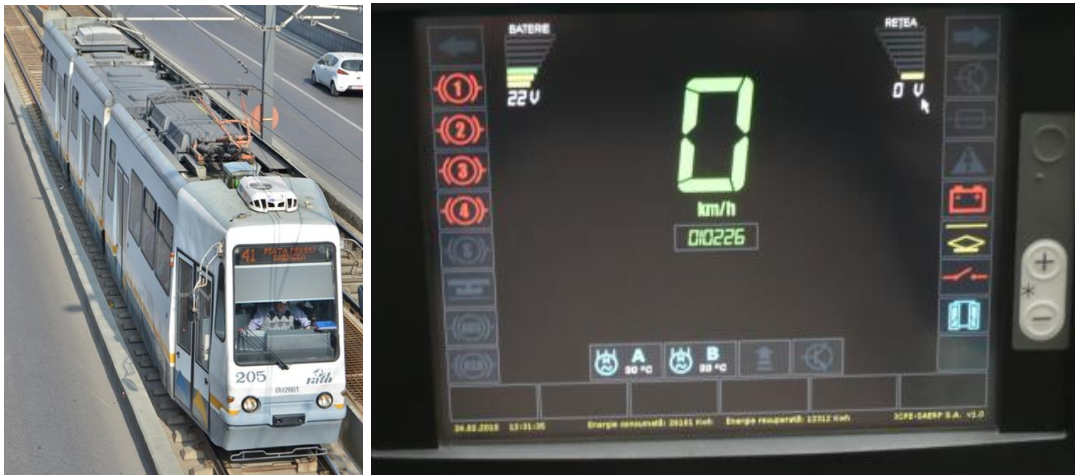
Figura 6. V3A-93-CA modernizare cu tracțiune în curent alternativ
