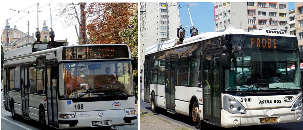
Figura 15. Troleibuz ASTRA Agora 12 m și Citelis 12 m cu tracțiune cu variator de curent continuu
