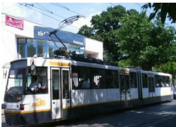
Figura 4. Tramvaie modernizate V2S-T și V2A-T cu variator de tensiune continuă
