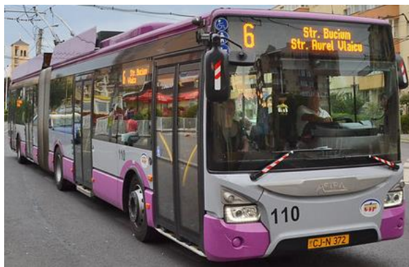
Figura 18. Troleibuzul Astra Urbanway 18 m prevăzut cu AC, HVAC și rezervor de energie cu supercapacitori
