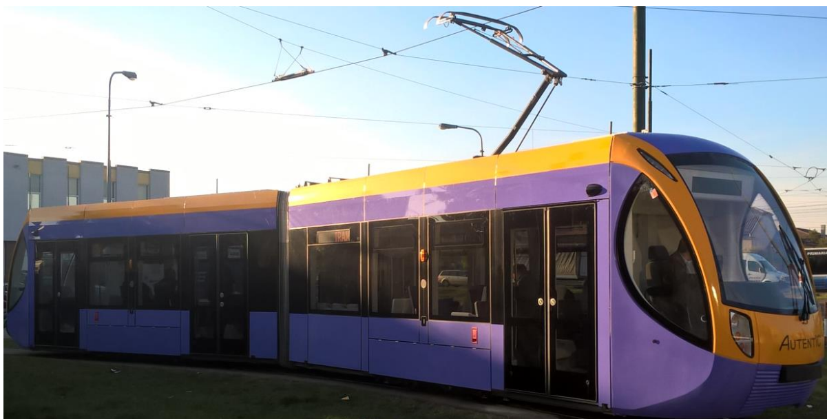
Figura 10. Tramvaiul Astra Autentic – construcție nouă, tracțiune în curent alternativ, aer condiționat, modularizat
