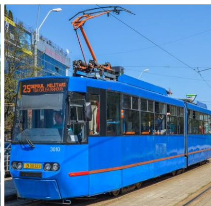
Figura 4. Tramvaie modernizate V2S-T și V2A-T cu variator de tensiune continuă
