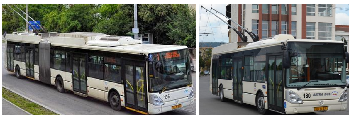
Figura 17. Troleibuzele ASTRA Citelis 12 m și 18 m cu tracțiune în CA și aer condiționat în salon
