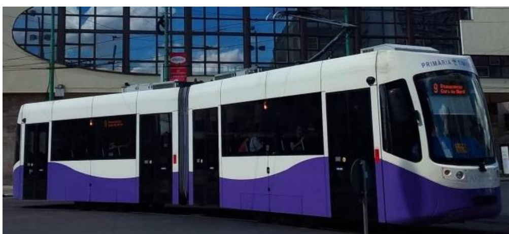
Figura 9. Tramvaiul GT4M Armonia modernizat cu tracțiune în curent alternativ și cu aer condiționat
