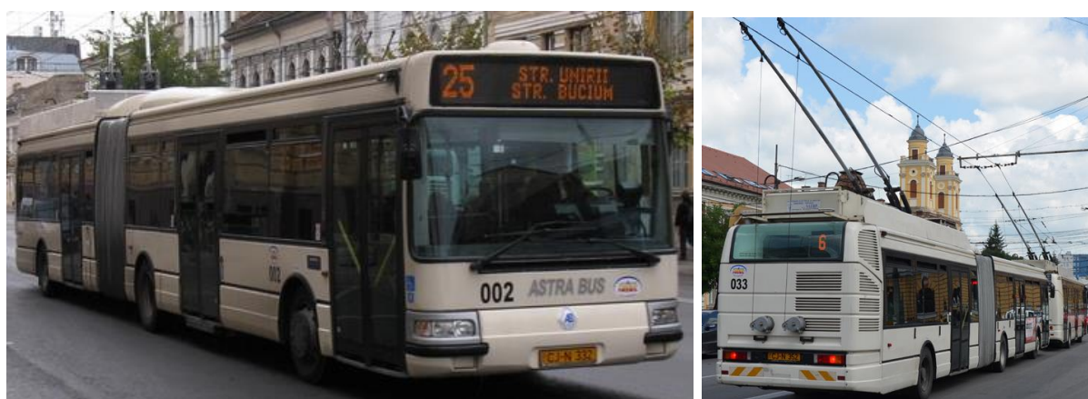
Figura 16. Troleibuz ASTRA Agora 18 m modernizat cu tracțiune în curent alternativ
